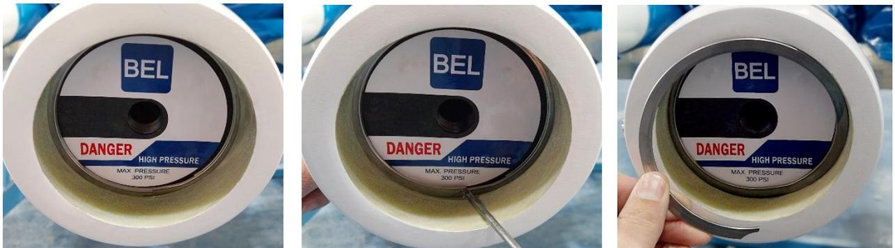
**Tubos de presión 600/1000/1200/1500 psi** – Usando un destornillador de punta plana. Insertar la punta del destornillador debajo del hueco del retaining ring, tirar hacia afuera y sacar la punta de la espiral. Seguir tirando, empujando con la punta del destornillador por la parte de atrás del retaining ring, siguiendo toda la circunferencia del retaining ring hasta que haya salido por completo. Una vez esté fuera, retirar los dos segmentos del support ring de la ranura.
